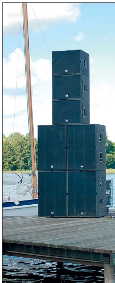
Jako system FOH rozstawiono Dynacord Cobra 4 w konfiguracji: dwa staki złożone z czterech zestawów niskotonowych PWH oraz trzech zestawów pełnopasmowych Cobra4TOP i Cobra4FAR.
