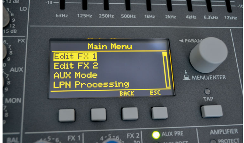
PowerMate 600-3 dysponuje wyświetlaczem OLED o dużym kontraście, który służy w trybie domyślnym do wyboru efektów, zaś po wciśnięciu gałki znajdującej się obok niego do edycji Menu.
