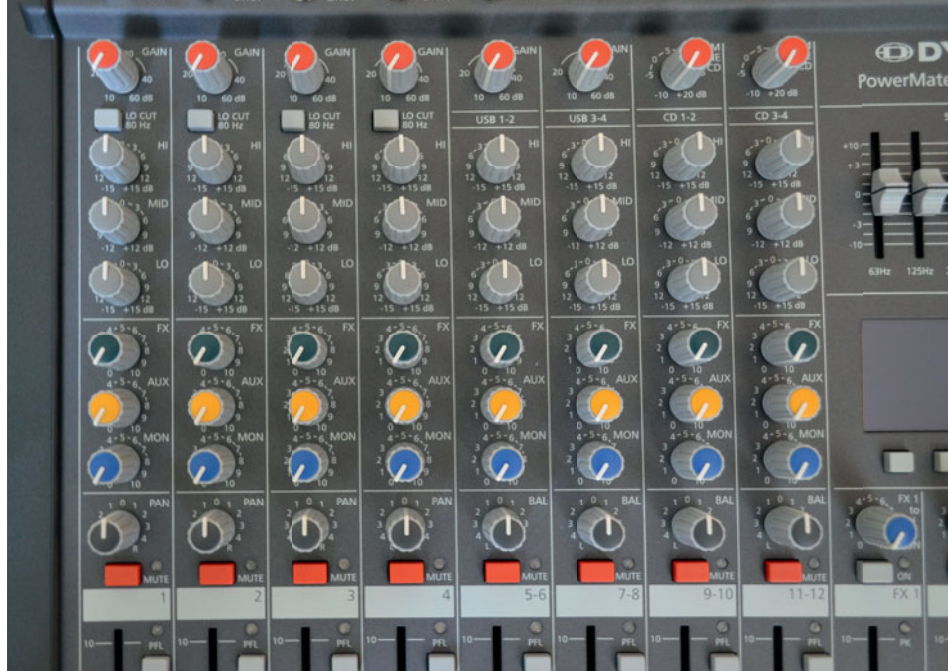
Trochę szkoda, że w korektorze zrezygnowano z półparametrycznego filtra środkowego, na rzecz filtra o stałej częstotliwości.
