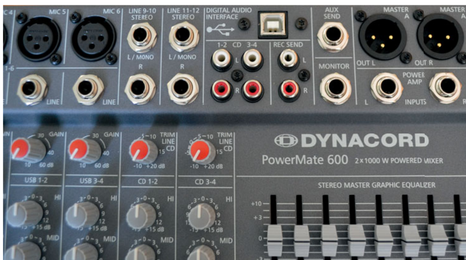
Odtwarzanie dwóch stereofonicznych tracków za pośrednictwem USB możliwe jest poprzez kanały 5 i 6, zaś kanały 9/10 i 11/12 „grają” sygnałem z wejść CD (cinch).
