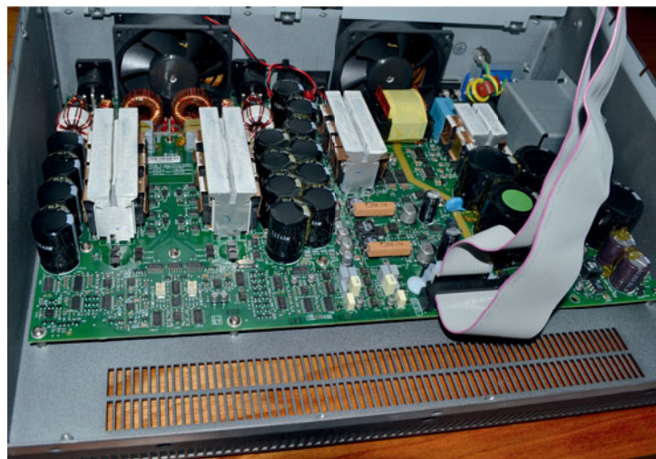
... która oddzielona jest od układów wzmacniacza i zasilacza metalową płytą, będącą zarówno ekranem, jak i „przedłużeniem” radiatorów tranzystorów mocy.
